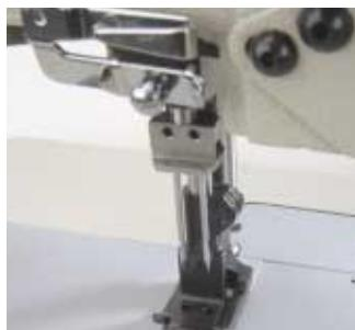
Standardně se stroje dodávají s rozpichem **6,4 mm**. Na přání lze dodat rozpichy: 3,2; 4; 4,8; 8; 9,5; 13; 16; 19; 25 mm.
