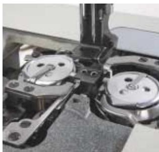
Odstřih nití zvyšující produktivitu práce je zajištěn robustním odstřihovým mechanismem. Jeho výhodou je jednoduché seřízení a dlouhá životnost.
