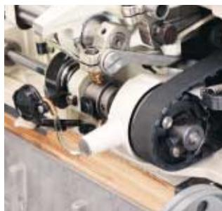
Bezpečnostní spojka zabrání připadnému poškození stroje při jeho zablokování.
